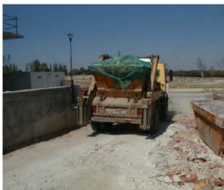
Figura 26. Ejemplo de cobertura de camiones para el transporte.
