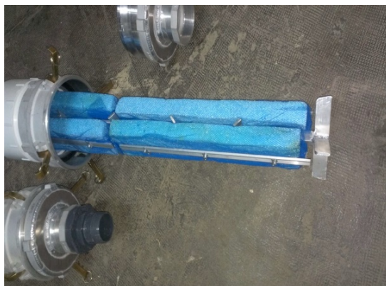
Figura 32. Disposición de las pastillas de polímero en el sistema de dosificación.
