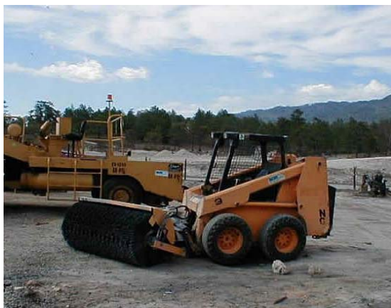
Figura 25. Ejemplo de Pala Barredora para la limpieza de los viales y acceso a la obra.
